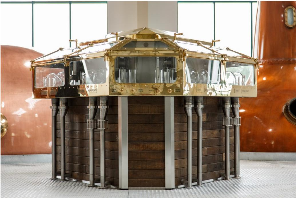
Der Spirit Safe dient der Qualitätskontrolle des Whiskeys. Mithilfe unterschiedlicher Instrumente wie Thermometer und Hydrometer entscheidet der Destillateur ab wann der Mittellauf beginnt und von Vor- und Nachlauf getrennt wird.
